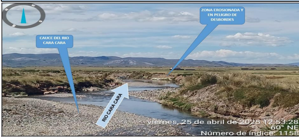
FIGURA 1 y 2 : TRAMO CRÍTICO EN EL RÍO ILLPAMAYO, EN EL SECTOR PIAS HUAYTA, DISTRITO DE LAMPA, PROVINCIA DE LAMPA - PUNO. NOTESE, LA ACUMULACION DE MATERIAL SEDIMENTADO EN EL CAUCE, QUE REQUIERE SER ELIMINADO PARA REESTABLECER LA SECCION HIDRAULICA DE LA CAJA DEL CAUCE EN ESTE SECTOR.
